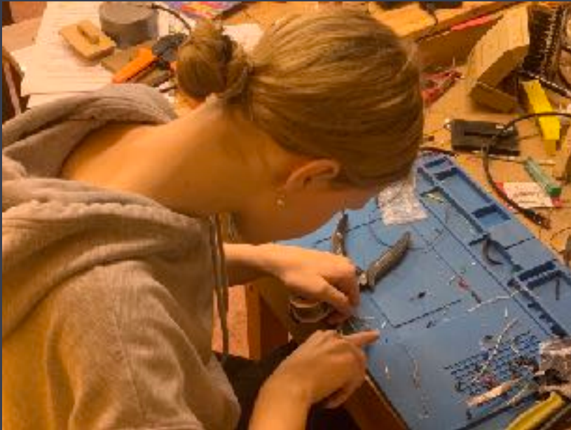
Widerstände an LED's löten
